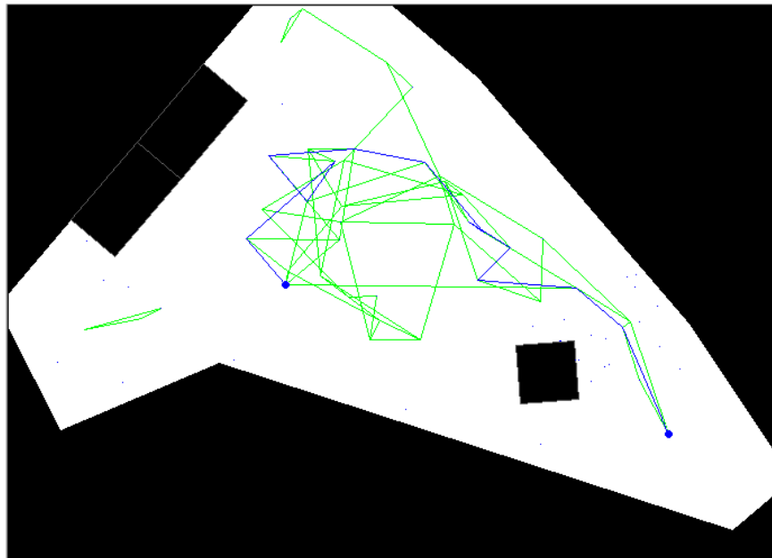
Figura 6.13: Resultado del algoritmo de “Backtracking”, limitando el número máximo de caminos encontrados a 10 y el número de iteraciones a 100000. Como puede observarse a simple vista, el algoritmo se detuvo antes de encontrar el camino más corto, cosa que, como veremos a continuación, no tiene porqué tener excesiva importancia.
